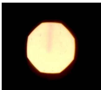
Изображение полевой диафрагмы после фокусировки и центрировки
