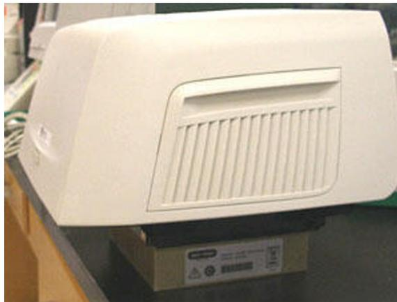
图 110. 放置光学模块以取出锁定板。
