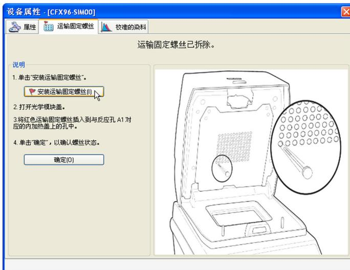
图 12. 安装运输固定螺丝的说明。
