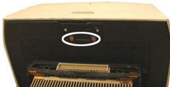
图 111. 卸下这两个螺丝以解除锁定光学模块。
