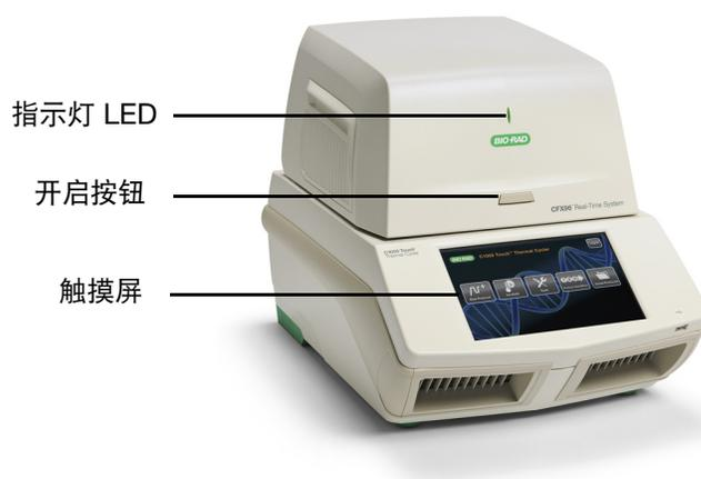
图 1. CFX96 Touch 系统的正面视图。
