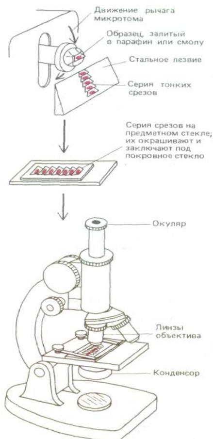
**Рис. 4-5.** Приготовление среза на микротоме после заливки ткани. Срез предназначен для исследования с помощью светового микроскопа. девают при охлаждении или за счет полимеризации, образуя твердый блок, который удобно резать на микротоме.
