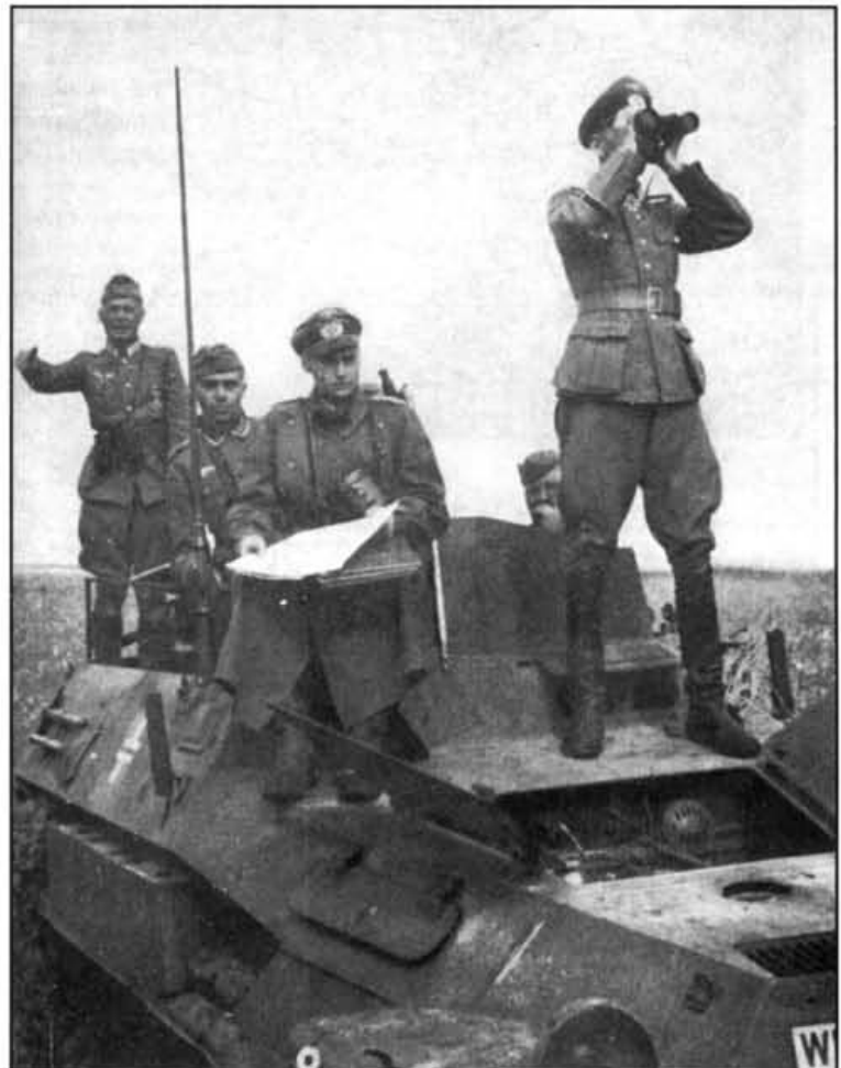
Командир дивизии обозревает поле боя с капота своего SdKfz 251/6 Ausf. B. Командирские бронетранспортеры оборудовались радиостанцией и, как правило, шифровальной машинкой "Enigma".
