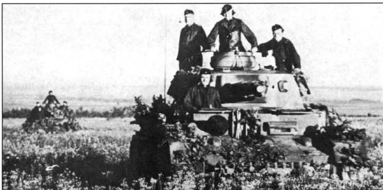
Два PzKpfw IV Ausf. F поддерживают наступление пехоты. Вооруженные короткоствольными 75-мм пушками, эти танки были малоэффективны против русских танков, но отлично подходили для поддержки пехоты.
