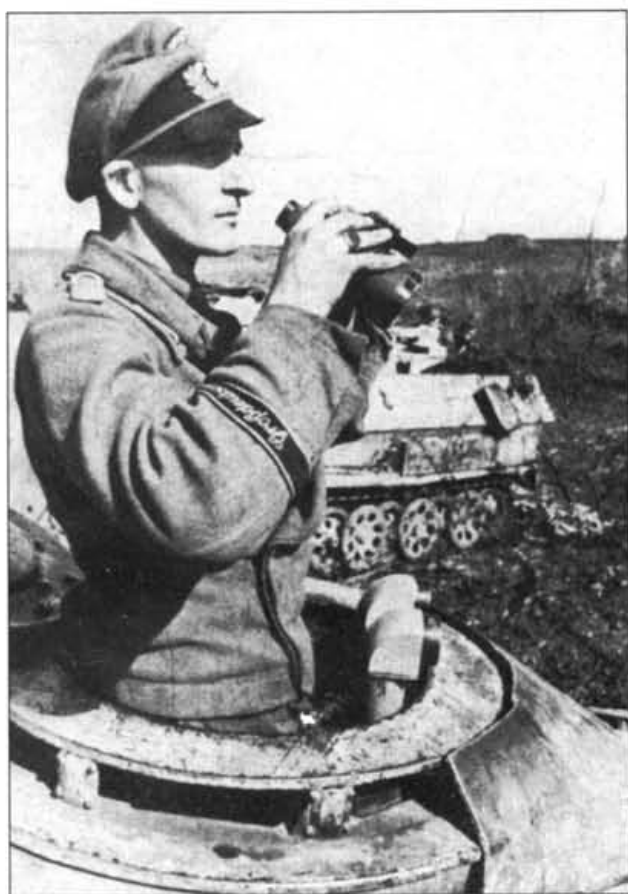
Командир StuG III Aufz. G осматривает местность через бинокль. Из люка торчат объективы стереотрубы. Обратите внимание, что спереди командирская башенка закрыта дополнительным листом брони.
