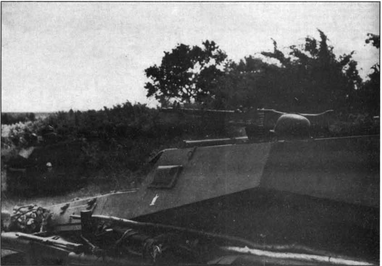
SdKfz 250/1. Виден станок, на котором установлен MG 34.
