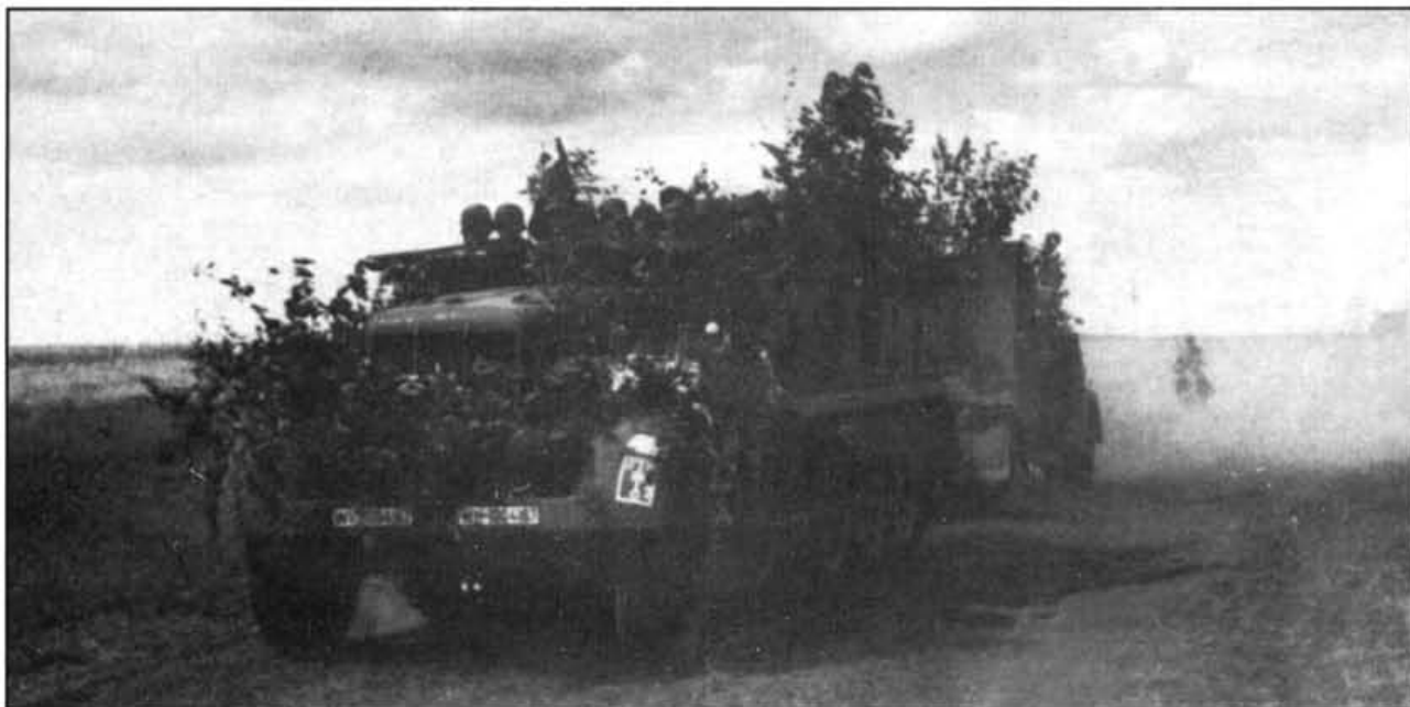
Закамуфлированный SdKfz 7 буксирует зенитное орудие 8.8 см Flak 36.
