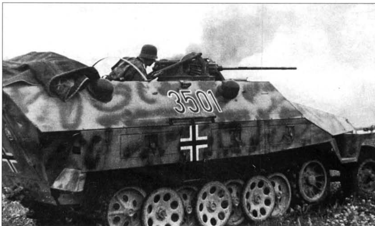
Любопытное вооружение несет этот командирский SdKfz 251/1 Ausf. D. Он вооружен 2 см MG 151/20, размещенной по схеме, принятой для SdKfz 251/17. Вероятно этот крупнокалиберный пулемет солдаты сняли с разбитого самолета.
