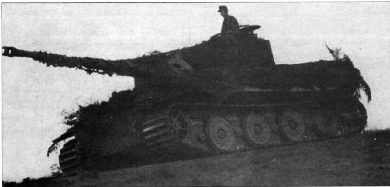
"Тигр" одного из поздних выпусков, что можно определить по опорным каткам с металлическим бандажом и командирской башенке. Танк замаскирован листвой, что было абсолютно необходимо в виду господства в воздухе авиации союзников.
