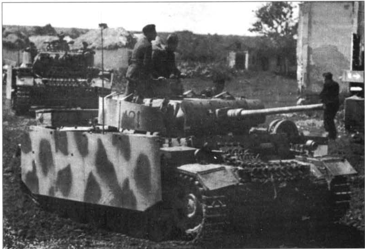
Танки Panzer III с бортовыми экранами. Фото сделаны в период Курской битвы.
