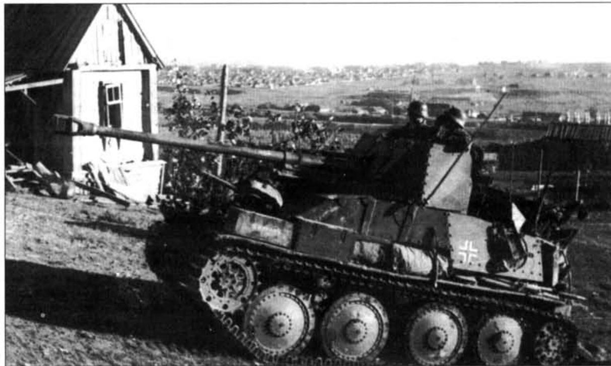
Истребитель танков «МардерIII» вооружался трофейной советской 76,2 мм противотанковой пушкой
