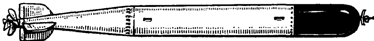
Постепенно торпеды приобрели идеальную форму тела вращения. Так выглядели торпеды Уайтхеда в начале XX века.
