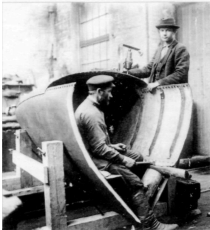
Строительство подводной лодки Джевецкого
