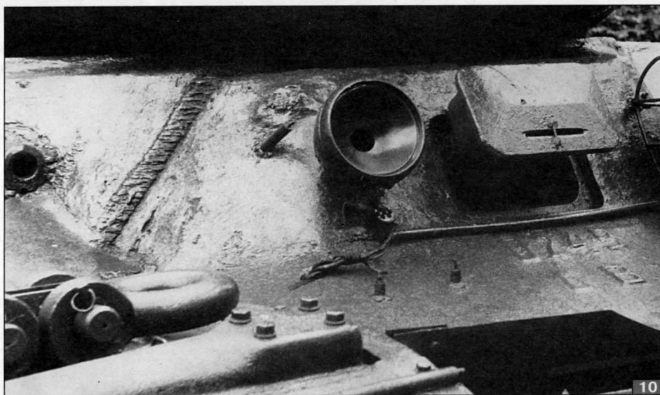
10. Смотровой люк механика-водителя и бронезащита курсового пулемета на корпусе со ступенчатой литой носовой частью.
