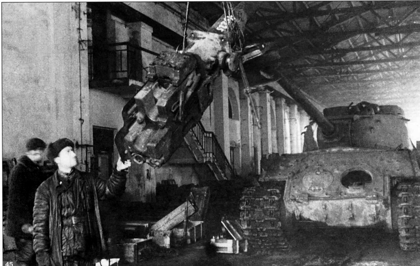
45. Ремонт пушки Д-25 с клиновым затвором.
