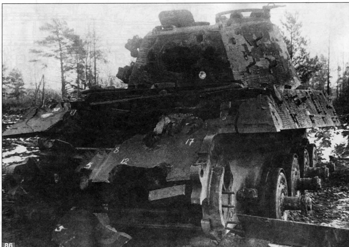
86. Бронекорпус и башня немецкого тяжелого танка Т-IVB «Тигр-II» № 102 после испытания снарядным обстрелом.
