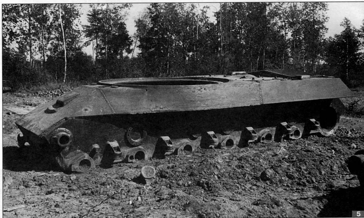
6. Корпус со спрямленной литой носовой частью производства завода № 200 танка ИС-2 (объект 240).
