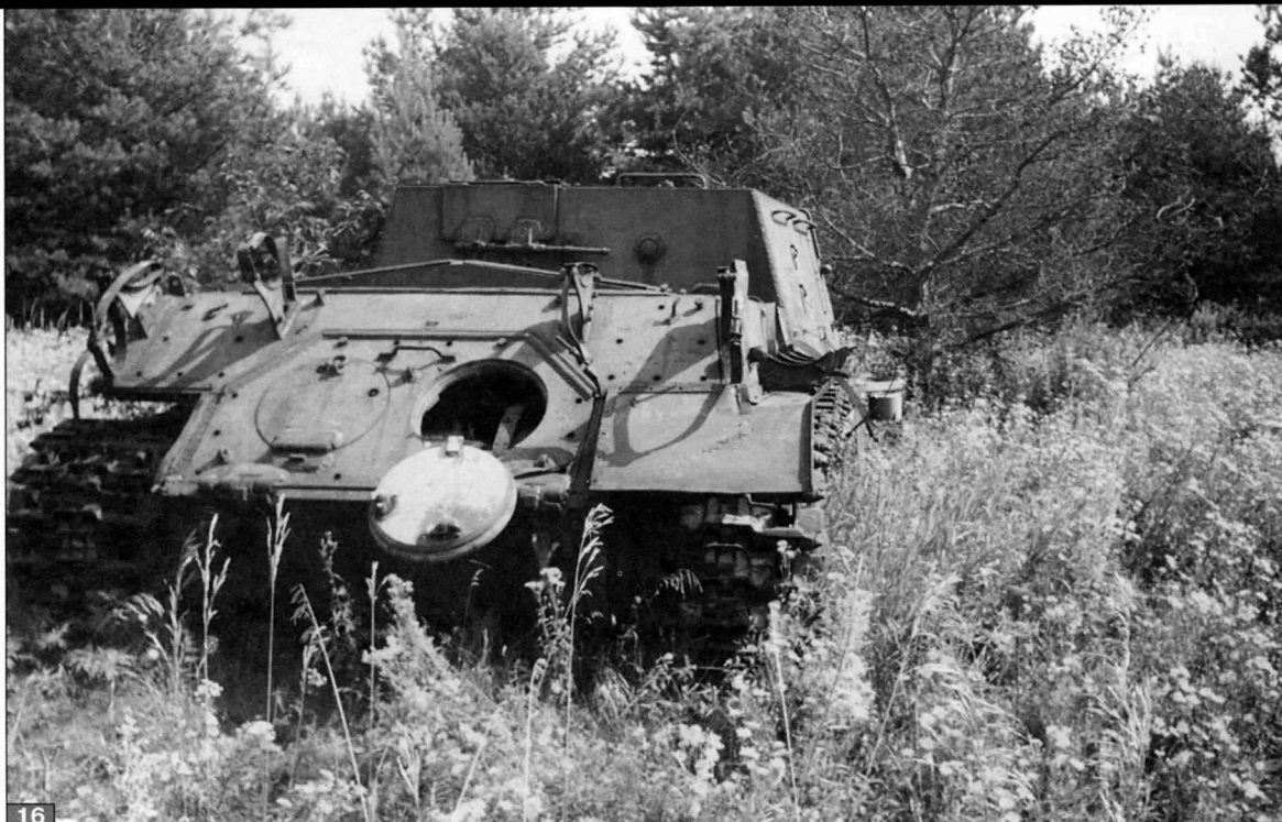
16. Люки трансмиссии, расположенные в кормовом листе корпуса для обслуживания.
