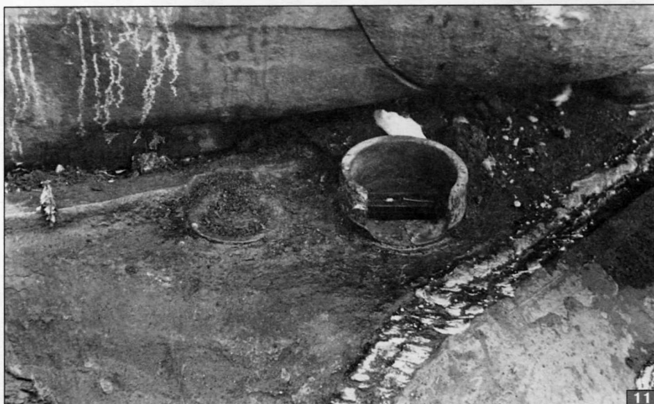
11. Правый смотровой прибор МК-IV механика-водителя на корпусе с катаной носовой частью.
