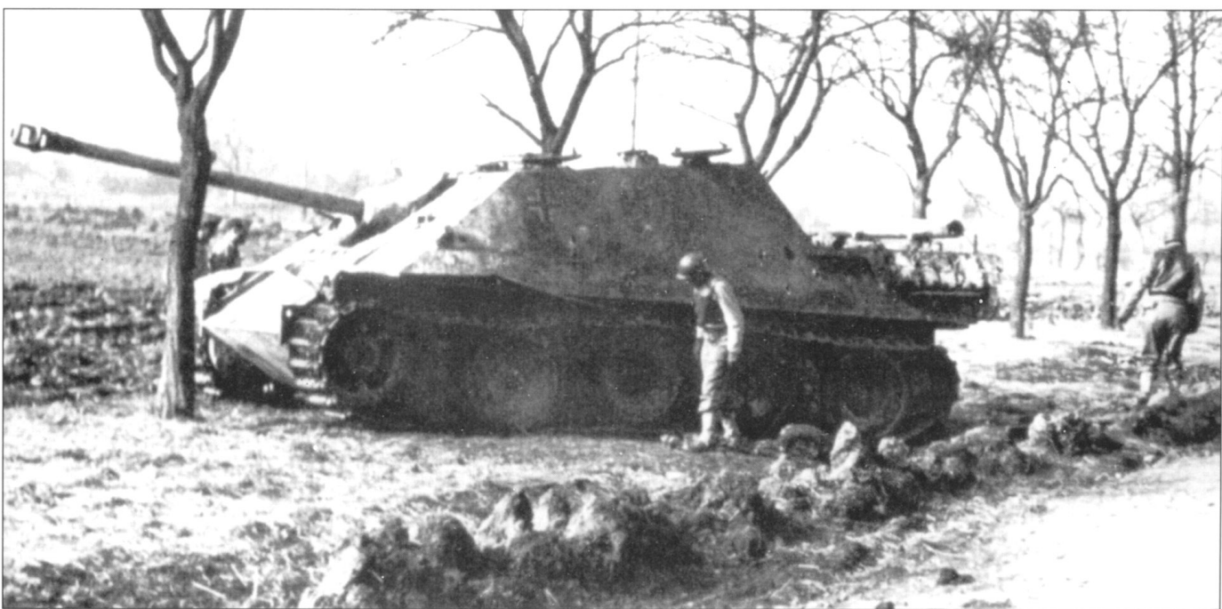
«Ядпантера» из 654-го тяжелого батальона истребителей танков на шоссе у Веккершира. Снимок сделан после того, как Кольмарский выступ был очищен от немцев американскими войсками. Ствол орудия находится в положении крайнего отката – машина выведена из строя экипажем. Скорее всего, самоходка поломалась или горючее кончилось. В бортовой броне рубки видны отметины от прямых попаданий снарядов. Различив крест на борту рубки и остатки цифр бортового номера «131».
