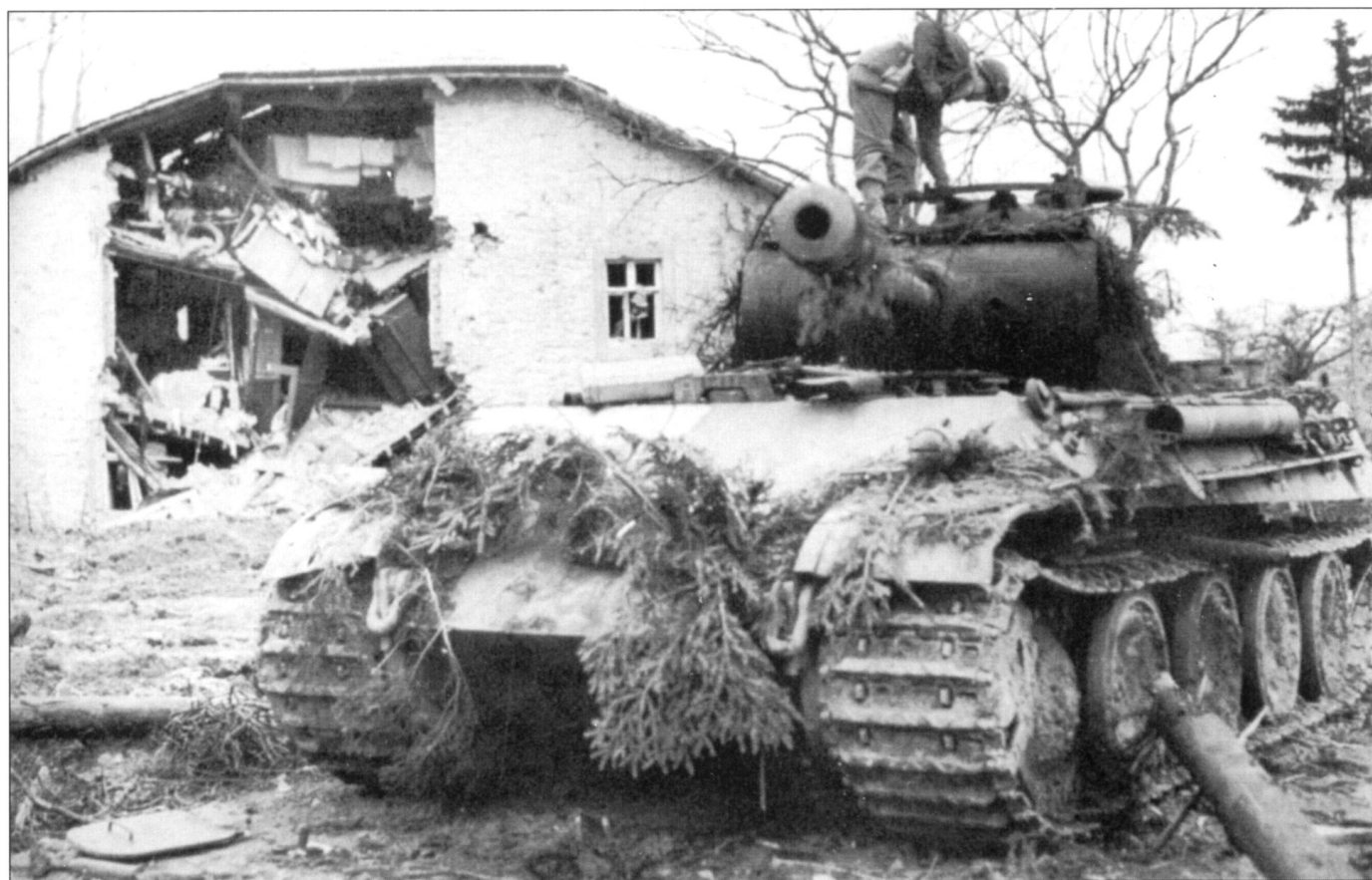
Американские солдаты из 75-й пехотной дивизии осматривают подбитую «Пантеру» Ausf. G из 2-й танковой дивизии СС, Грандменил, конец декабря 1944 г. «Пантера» - постройки октября 1944 г. с увеличенным вентилятором для системы обогрева боевого отделения. В августе 1944 г. на «Пантеры» стали ставить сбрасываемые в аварийной ситуации люки механика-водителя и стрелка-радиста, один такой люк валяется на земле левее танка.
