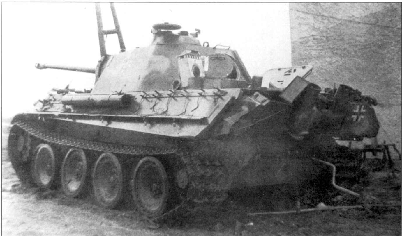
Новенькая «Пантера» Ausf. G, вероятно из 9-й панцердивизии, брошенная в Клервю, Люксембург, из-за неполадок по механической части. Машина поздней постройки – с маской пушки «подбородочного» типа. На выхлопных патрубках установлены пламегасители. Танк снабжен новыми самоочищающимися литыми ленивцами увеличенного диаметра. Цифры бортового номера «301» нанесены белым контуром на бортах башни и просто белой краской на корме.
