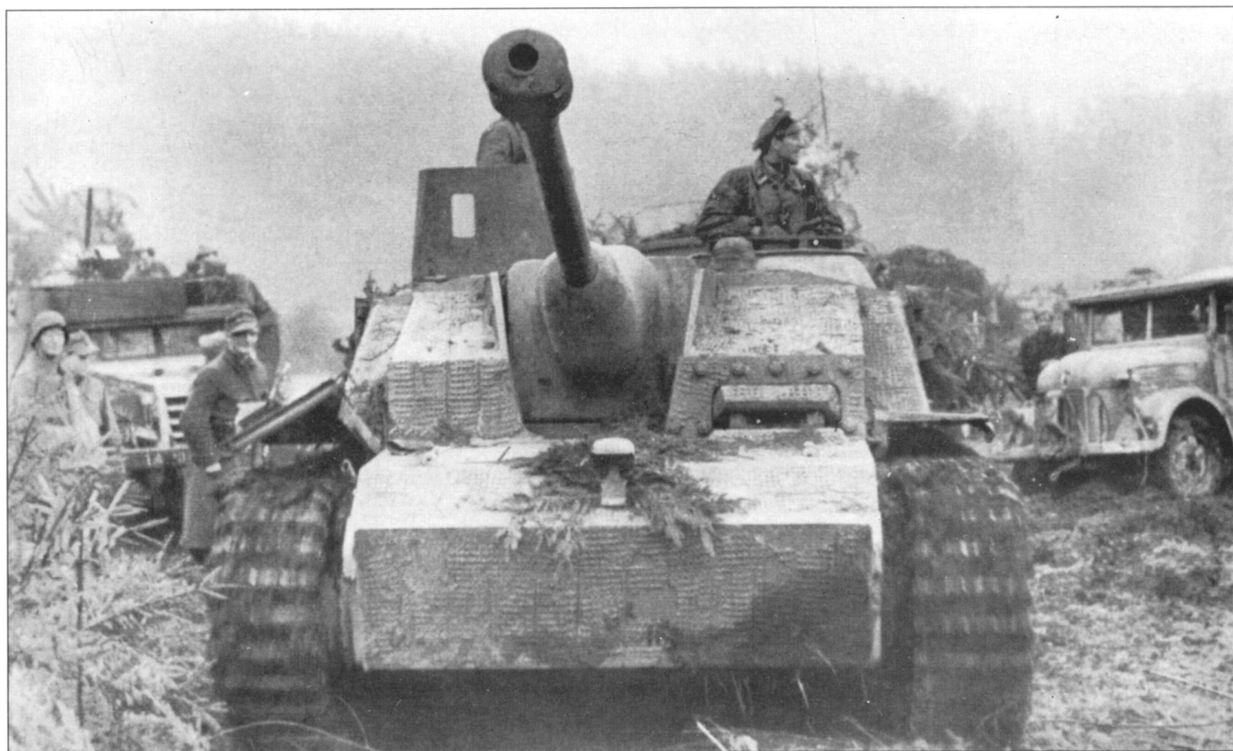
Штурмовое орудие StuG III Ausf. G из неустановленного подразделения войск СС. Машина построена фирмой Алкетт – для самоходок этой фирмы уникален рисунок циммерита «вафельный». Пушка штурмового орудия установлена в маске типа «Topfblende», которую часто называют «Saikorof». В правой части корпуса установлена одна бронеплита толщиной 80 мм, закрепленная болтами. Вероятно машина принадлежала или 2-й, или 9-й танковой дивизии СС, в составе 2-х батальонов которых имелось по две роты штурмовых орудий StuG III/IV. Справа – автомобиль Штейр 1500А/01, слева – трофейный американский бронетранспортер М2А1 или М3А1 с кодом американской 1-й армии на бампере.
