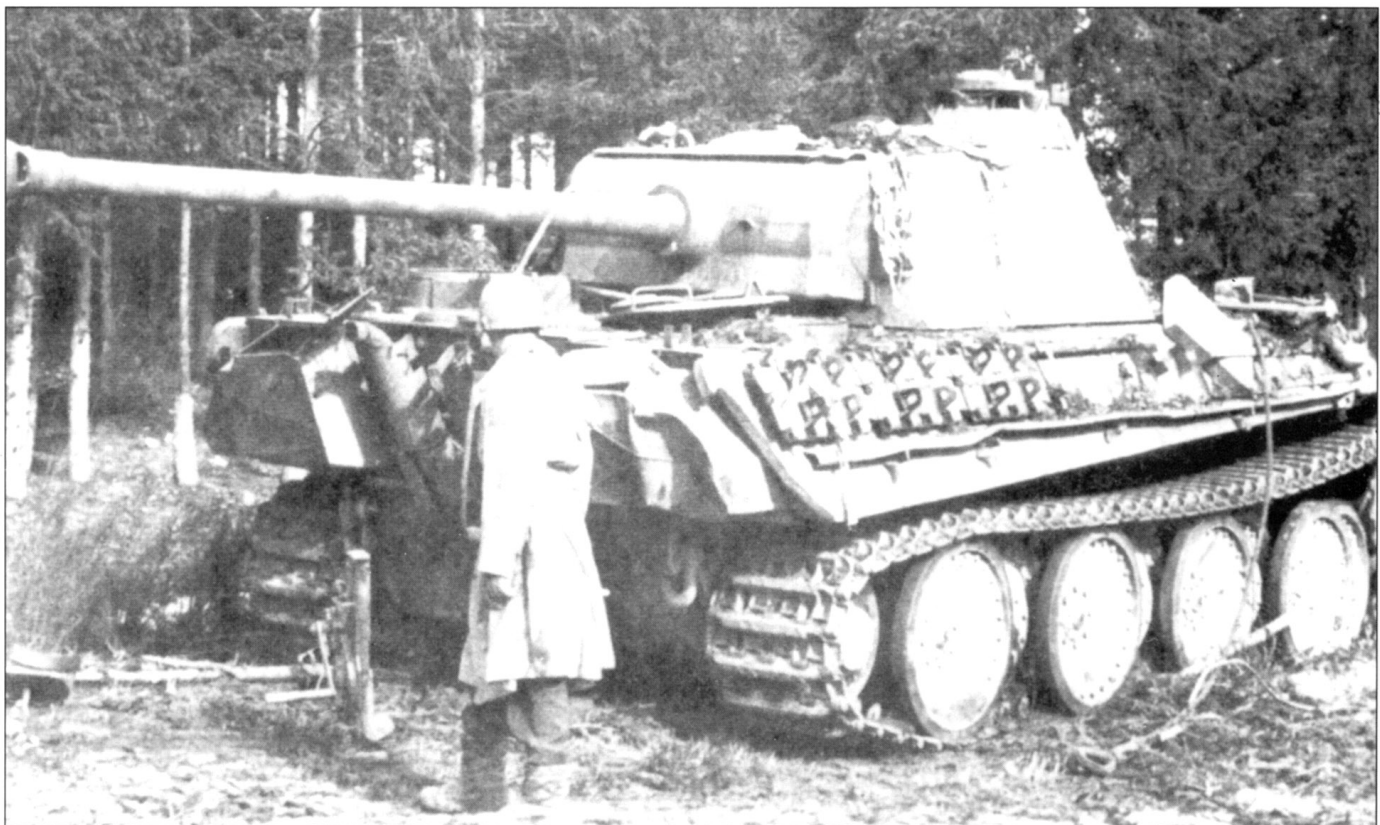
«Пантера» Ausf. G, вероятно из того же подразделения, что и «Пантера» на предыдущем снимке. Машина – поздней постройки: маска с «подбородком». Увеличенный колпак вентилятора, однако выхлопные патрубки раннего типа и ранние ведущие колеса. Необычно нанесен крест – на борту башни. Цифры бортового номера «302» написаны белым контуром.
