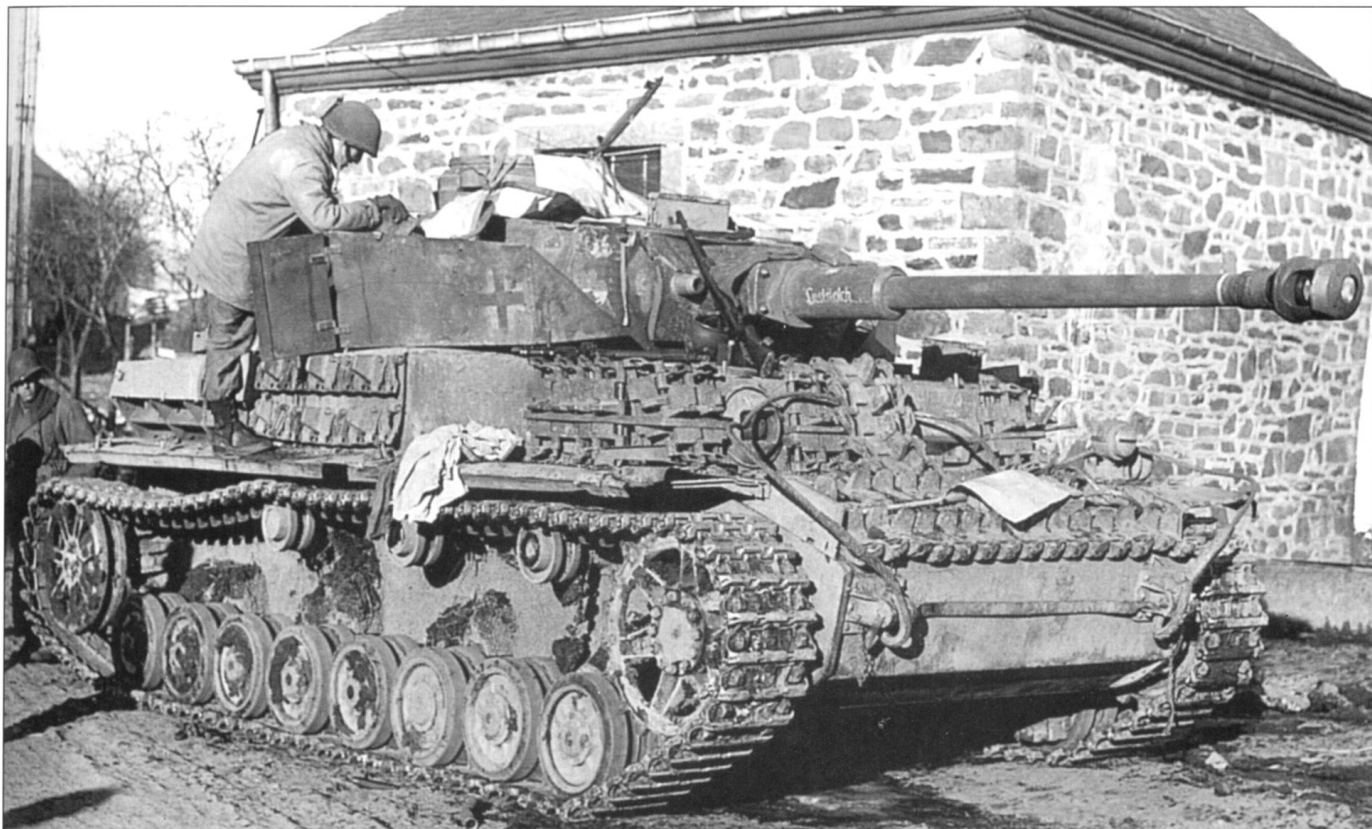
Танк Pz.Kpfw. IV Ausf. J из кампфгруппы Мауке, подбитый людьми полковника Чаппи из 502-го парашютно-пехотного полка в Чампсе 26 декабря 1944 г. Танк собран в конце сентября 1944 г. – циммерита уже нет. Один ролик утрачен по неизвестной причине. На бронекорпусе откатника ствола орудия сделана надпись «Lustmolch» (секс-фанатик), ближе к дульному тормозу на стволе нанесена кольцевая марка в память об уничтоженной цели.
