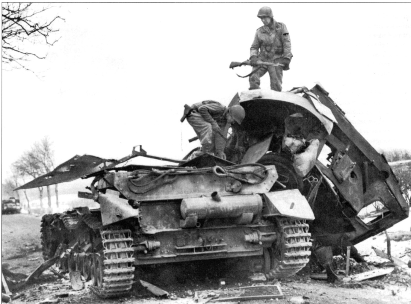
Два американских солдата осматривают подбитый танк Pz.Krfw. IV Ausf. J из 6-й роты 1-го танкового полка СС, подбитый самоходкой M10 из 644-го батальона истребителей танков под Вирицфельдом 17 декабря. Танк построен в сентябре – октябре 1944 г. уже после того как поступило распоряжение прекратить нанесение циммерита. Танк оснащен новыми проволочными бортовыми экранами. Необычен цилиндрический глушитель старого типа. Танки поздней постройки (с августа 1944 г.) оснащались вертикальными выхлопными патрубками с пламегасителями. В борту башины видна сквозная пробоина от снаряда. Вдали стоит еще один подбитый танк Pz.Krfw. IV.
