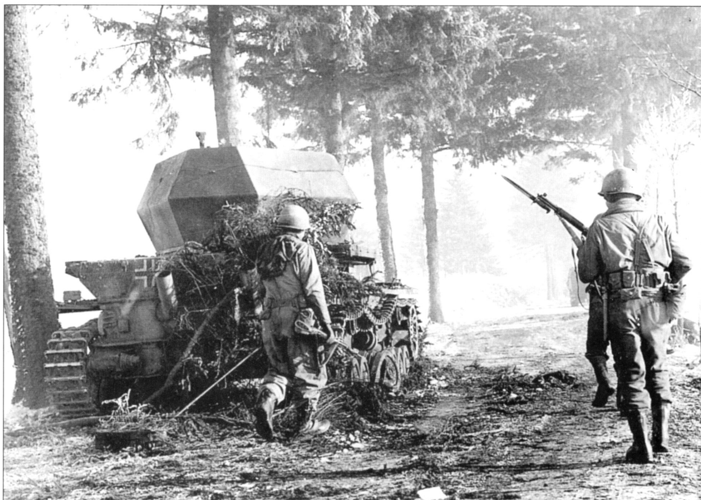
Разбитый Flakpanzer IV Wirbelwind на шоссе под Компоном, что севернее Бастони, 15 января 1945 г. Выхлопные патрубки зенитного танка оснащены пламегасителями – ЗСУ сделана на шасси танка Pz.Kpfw. IV Ausf. J. Снаряд, попавший в зенитный танк, почти оторвал один ролик и разрушил два опорных катка.
