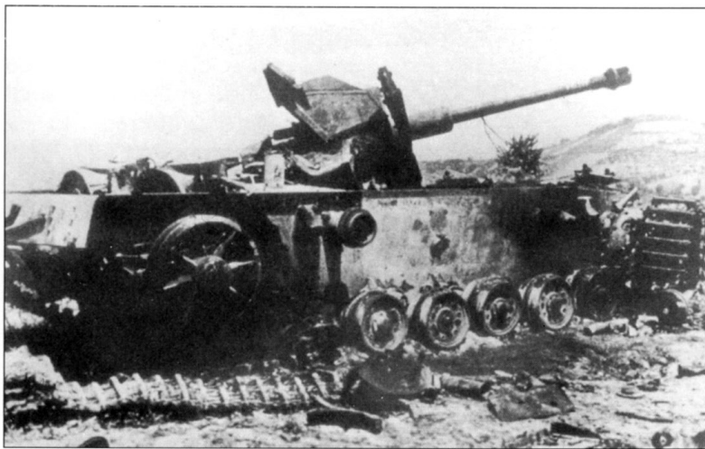
Остатки сгоревшего штурмового орудия StuG III Ausf. G, район Болоньи, весна 1945 г. Это была самоходка поздней постройки, не ранее сентября 1944 г. - отсутствует циммерит. До того как самоходка сгорела, ее экипаж успел подбить пять танков союзников, см. кольца на стволе пушки.
