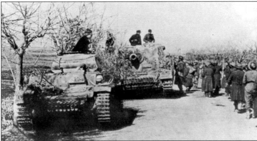
Sturmtiger IV из Sturmtiger-Abteilung 216 проехал мимо поврежденного или обломавшегося «Тигра» Ausf. E из 508-го батальона тяжелых танков, район Анцио. Sturmtiger IV построен на шасси танка Pz.Kpfw. IV Ausf. G. Отверстие под выхлопной патрубок моторчика разворота башни танка в кормовом бронелисте корпуса самоходки закрыт металлическим листом. Правее танкиста, который стоит на крыше моторного отделения, виден колпак вентилятора боевого отделения раннего типа. На заднем плане, левее самоходки, виден полугусеничный тягач Sd.Kfz. 9 Фамо. Тягач готовится к буксировки «Тигра».
