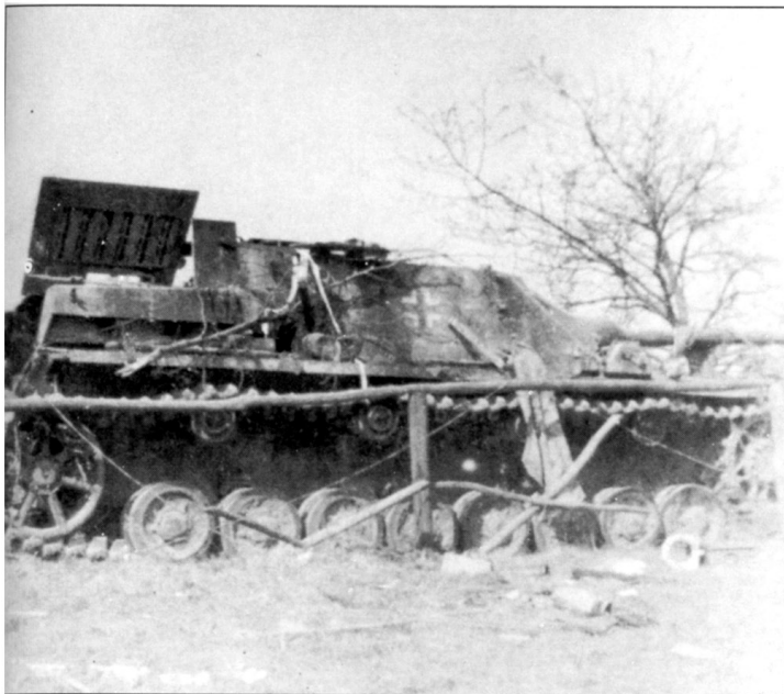
Штурмовое орудие StuG IV поздней постройки из 1034-го батальона штурмовых орудий 34-й пехотной дивизии, брошено где-то на ферме. Скорее всего, у самоходки перегрелся мотор - открыты люки доступа к двигателю. Боевых повреждений не заметно. В Италии самоходки StuG IV имелись только в 34-й пехотной и в 90-й панцергренадерской дивизиях. 34-я дивизия появилась на Апеннинах в конце сентября или в начале октября 1944 г. Данный образец штурмового орудия изготовлен после сентября 1944 г., так как на штурмовое орудие не нанесен циммерит. Нанесение циммерита отменили в сентябре 1944 г. Штурмовое орудие полностью выкрашено темно-желтой краской и камуфлировано пятнами зеленого и коричневого цвета. На рубке нарисован черно-белый крест.
