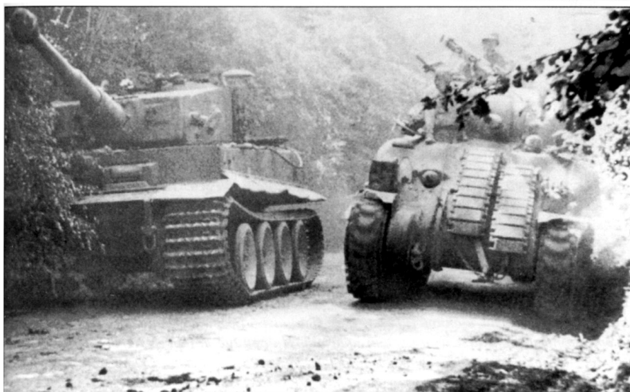
Ранний М4А1 «Шерман» объезжает брошенный на дороге «Тигр» из 508-го тяжелого танкового батальона. Видимых повреждений на «Тигре» нет, скорее всего танк действительно просто бросил экипаж, может топливо кончилось? Дульный тормоз пушки «Тигра» закрыт чехлом. Сама пушка зафиксирована в походном положении.
