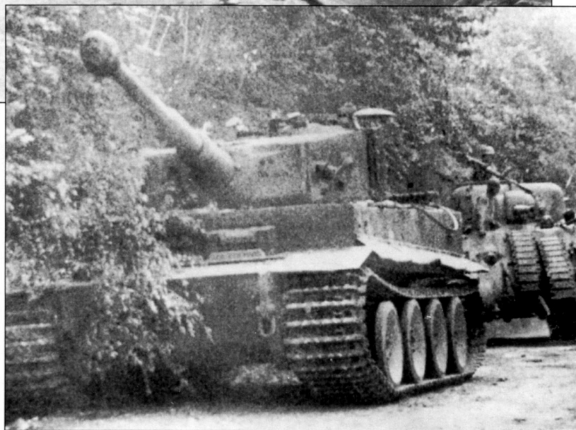
Ранний М4А1 «Шерман» объезжает брошенный на дороге «Тигр» из 508-го тяжелого танкового батальона. Видимых повреждений на «Тигре» нет, скорее всего танк действительно просто бросил экипаж, может топливо кончилось? Дульный тормоз пушки «Тигра» закрыт чехлом. Сама пушка зафиксирована в походном положении.
