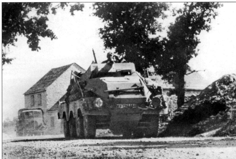
Бронеавтомобиль Sd.Kfz. 233 schwere Panzerspahwagen (7,5 cm) на пыльной итальянской дороге. Броневик окрашен в темно-желтый цвет и несет стандартную маркировку вермахта вкупе с номерным знаком «WH 1312055», номерной знак - белый, цифры и буквы номера - черные. Всего с июля 1942 г. по октябрь 1943 г. было построено 129 бронеавтомобилей Sd.Kfz. 233. Обычно такие машины состояли на вооружении разведывательных батальонов танковых дивизий.
