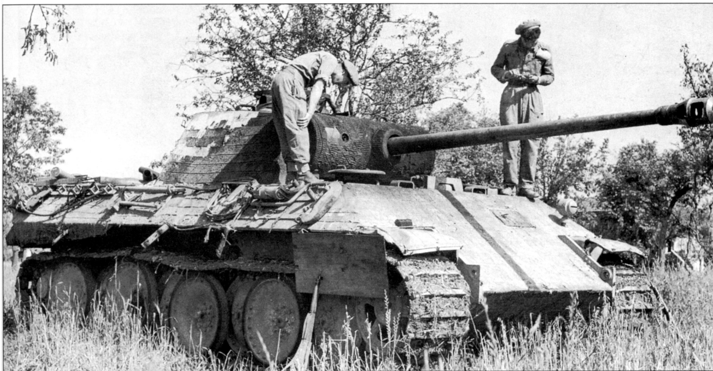
Два британских солдата осматривают «Пантеру» Ausf. А из 1-го батальона 4-го танкового полка. Танк подбит в бою при Акино в нескольких километрах от Монте-Кассино в мае 1944 г. Ствол пушки заклинило в положении неполного отката.
