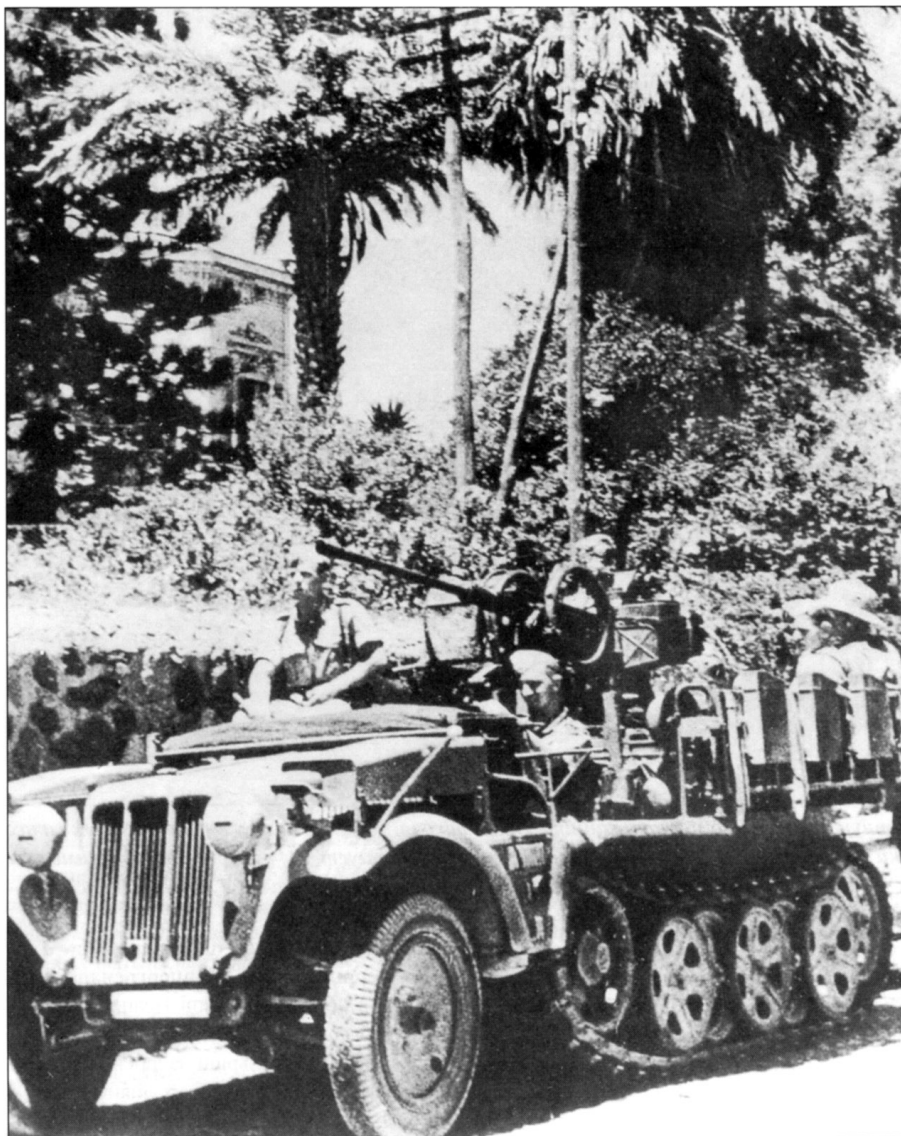
Самоходно-артиллерийская установка Sd.Kfz. 10/4 одного из подразделений люфтваффе на фоне пальм Южной Италии, лето 1943 г. С 1938 по 1944 г.г. промышленность рейха изготовила 610 зенитных самоходок Sd.Kfz. 10/4, вооруженных 20-мм пушками Flak-30 или пушками Flak-38 того же калибра. В качестве шасси был использован полугусеничный тягач Демаг D7.
