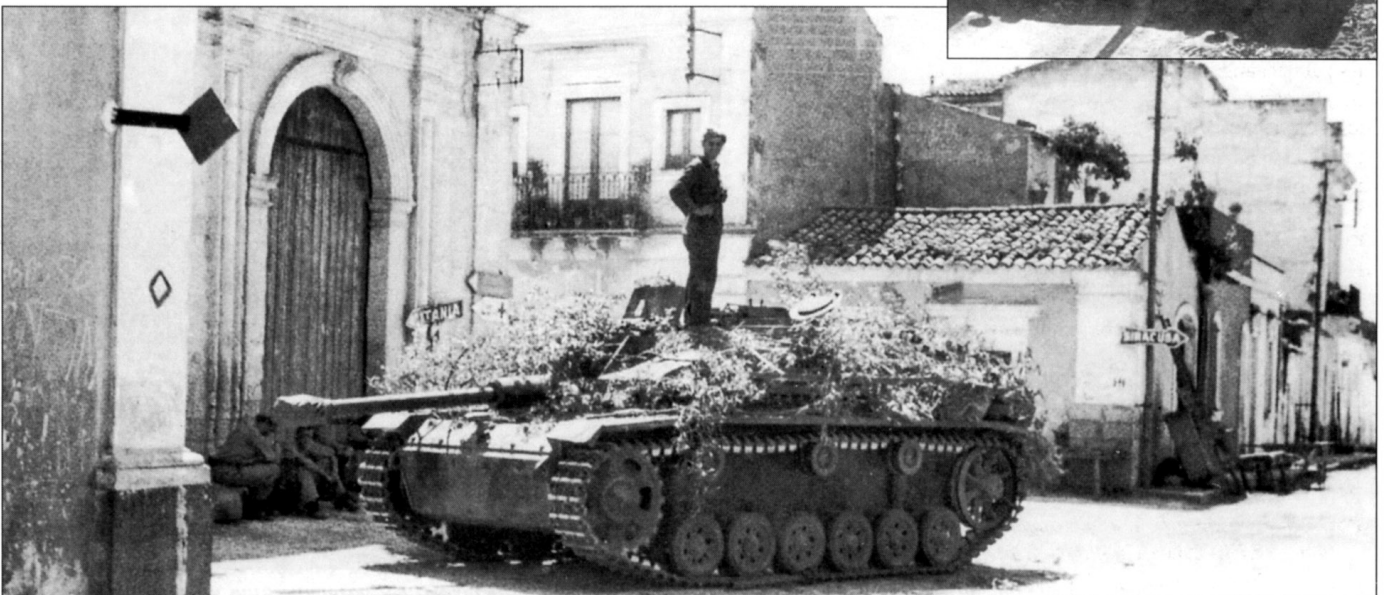
Штурмовая гаубица StuH-42 Ausf. G и штурмовое орудие StuG III Ausf. G из 3-го батальона танкового полка «Герман Геринг» на оборонительной позиции у побережья. Обе самоходки основательно замаскированы ветками, которые совершенно исказили силуэты боевых машин.
