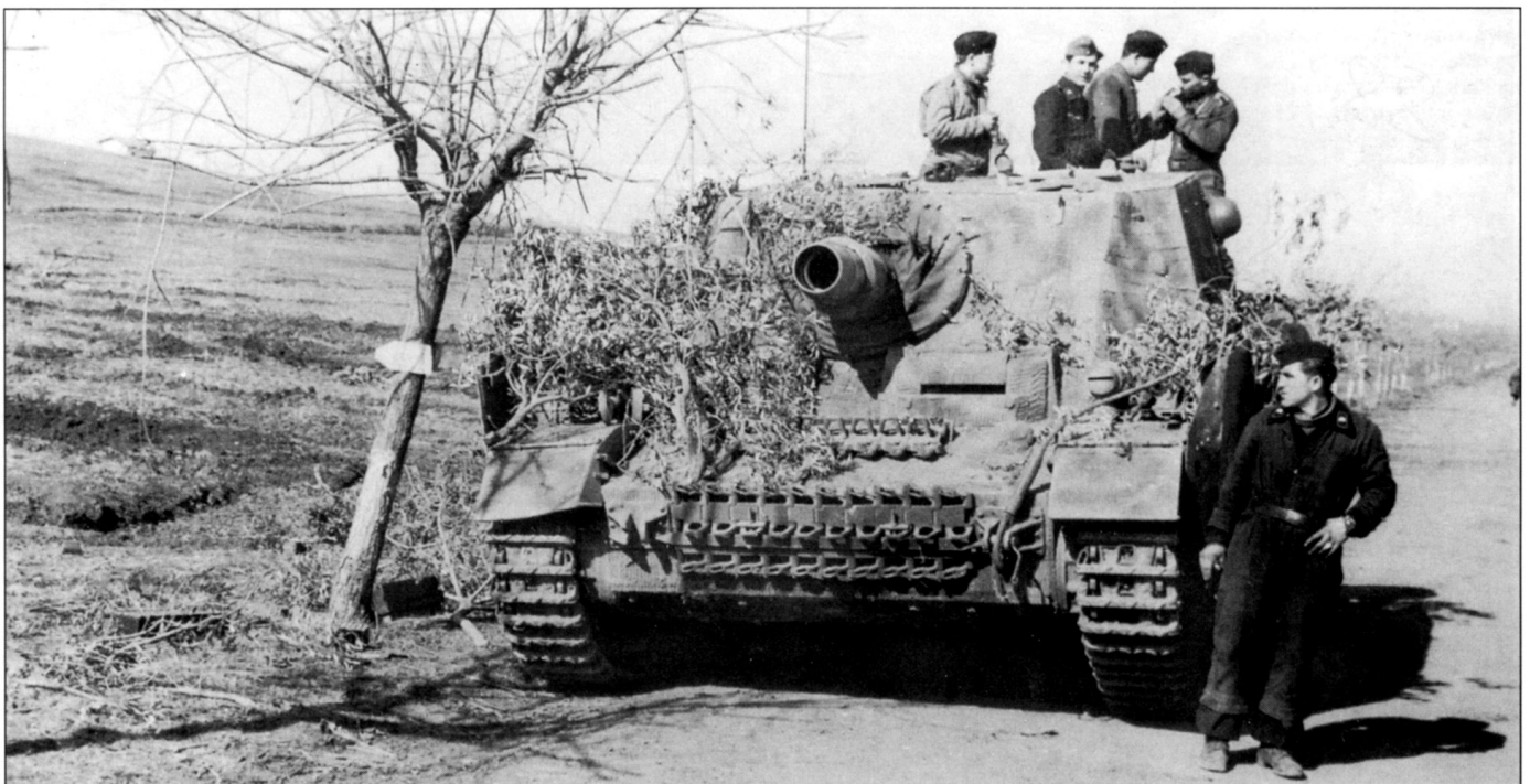
Sturmtiger-Abteilung 216 также был в феврале 1944 г. переброшен к Анцио - Неттуно. 216-й батальон первым получил самоходки Sturmtiger IV и очень успешно сражался в июле 1943 г. на Курской дуге. На снимке - самоходка среднего выпуска, изготовленная на шасси танка Pz.Kpfw. IV Ausf. H. На переднем плане - абсолютно устаревший танк Pz.Kpfw. II Ausf. A-C, вероятно - командирская машина. Навстречу бронетехники движется колонна британских военнопленных. Штурмтанк окрашен в темно-желтый цвет и камуфлирован пятнами случайной формы и случайного местоположения. Маска закрыта чехлом. Член экипажа, который стоит возле самоходки, одет черную униформу танкиста, в петлицах куртки также закреплены эмблемы панцерваффе.
