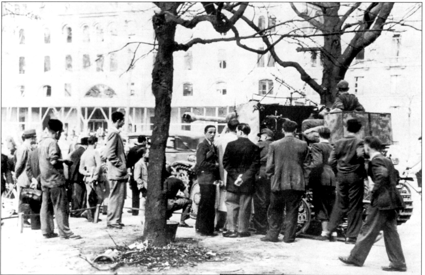
Самоходка 7,5 см PaK-40/3 auf Panzerkampfwagen 38(t) Ausf. H (Sd.Kfz. 138) из неустановленного батальона истребителей танков, Италия, конец 1943 г. Этот истребитель танков более известен как «Мардер III» Ausf. H. На корме самоходки установлен большой ящик для имущества, сделанный силами полевых ремонтников.
