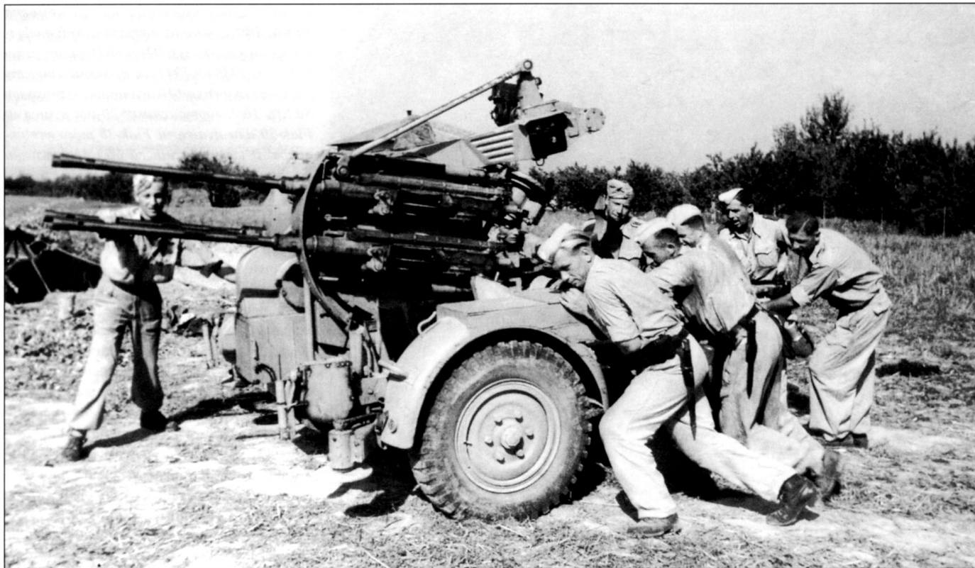
Расчет выкатывает счетверенную 20-мм зенитную пушку на огневую позицию. Такие орудия использовались в вооруженных силах Германии повсеместно, но формально все пушки принадлежали люфтваффе, по состоянию на август 1944 г. в люфтваффе имелось примерно 3600 20-мм зенитных счетверенных пушек. Скорострельность системы составляла 800 выстрелов в минуту, максимальная эффективная дальность поражения целей - 2200 м.
