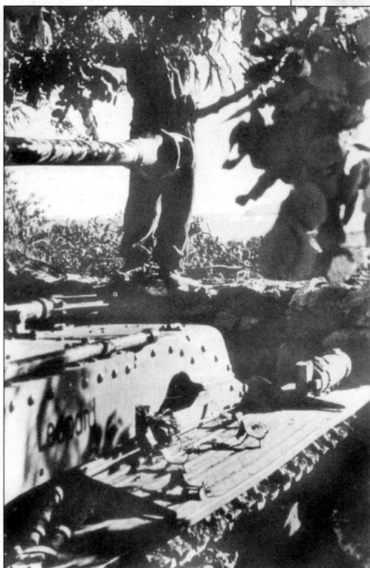
Истребитель танков «Мардер III» Ausf. M ранней постройки на огневой позиции. Машина частично закрыта спереди каменной кладкой. Командир самоходки осматривает местность в бинокль. Название машины, «Leopard», написано на борту корпуса предположительно черной краской. На ранние «Мардеры III» ставились литые рубки механиков-водителей с скругленными кромками. Сварные рубки появились в конце 1943 г.
