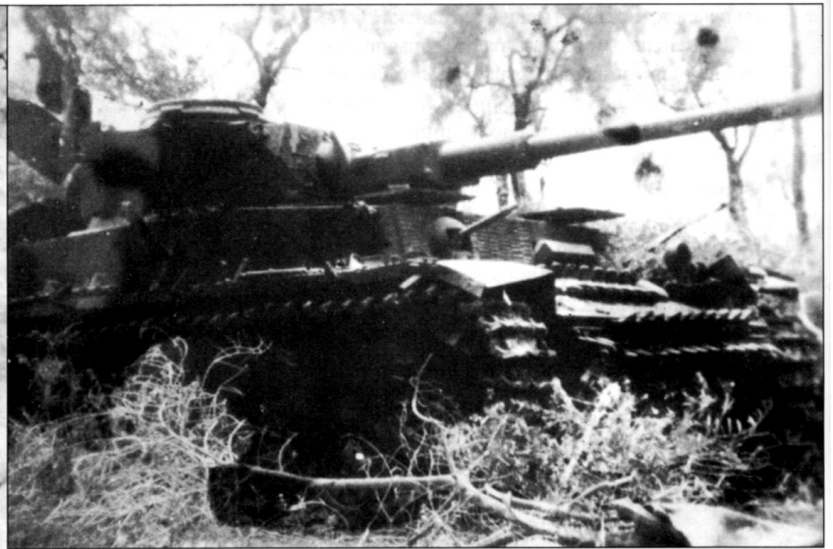
Танк Pz.Kpfw. IV Ausf. H, подбитый под Кассино в начале 1944 г. На лобовой части корпуса просматривается циммерит.
