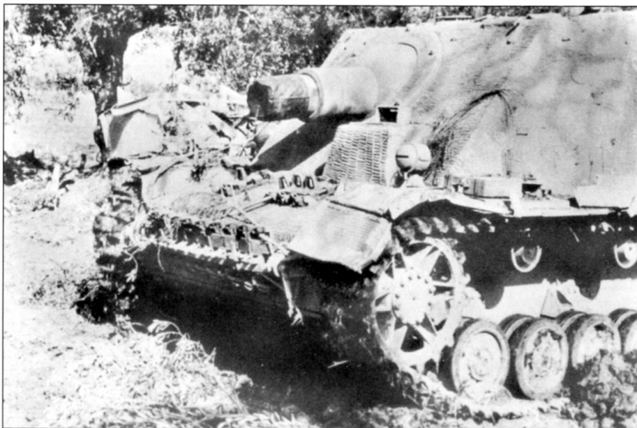
Sturmpanzer IV позднего типа, машины поздней постройки отличались наличием коробчатого выступа в районе отделения управления. В крыше этого выступа установлен поворотный перископический наблюдательный прибор. Камуфляж состоит из пересекающихся крест накрест извилистыми линиями. На снимке не видно, но на борту рубки изображены крест (черными скобками) и номер «1» белого цвета.
