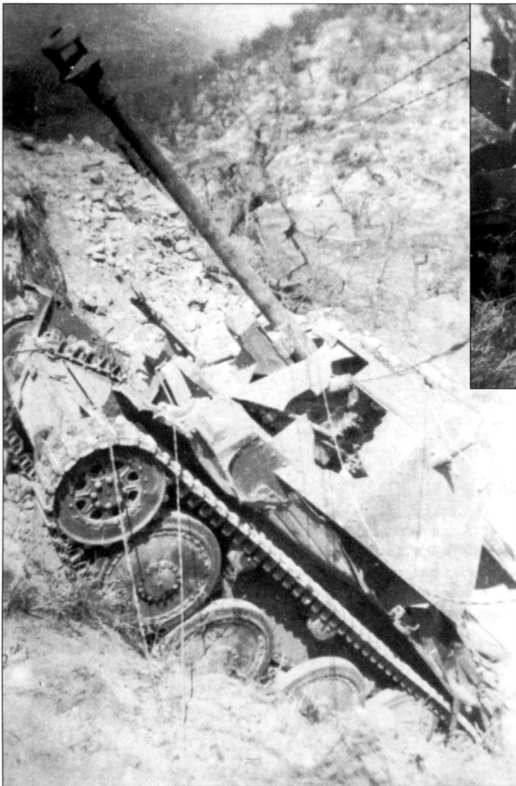
Танк Pz.Kpfw. IV Ausf. H, подбитый под Кассино в начале 1944 г. На лобовой части корпуса просматривается циммерит.
