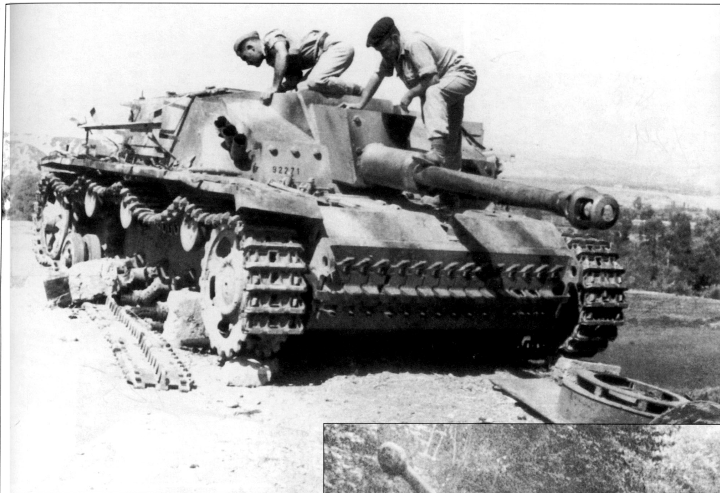
Штурмовое орудие StuG III Ausf. G раннего выпуска осматривают двое британских солдат, лето 1944 г. По углам рубки самоходки установлены дымовые гранатометы, гранатометы ставились только на самоходах постройки февраля - мая 1943 г. Крепления для бортовых экранов установлены на штурмовом орудии в полевой ремонтной мастерской. Номер шасси «92271» нанесен на накладную броню, закрепленную на рубке болтами.
