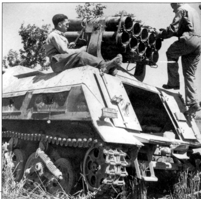
Два солдата союзных войск осматривают броненную самоходную установку 15 см Panzerwerfer-42 (Sd.Kfz. 4/1). С апреля 1943 г. по март 1944 г. было изготовлено 300 установок Panzerwerfer-42, еще 19 машин переделали из Munitionskraftwagen fur Nebelwerfer в июне 1944 г.
