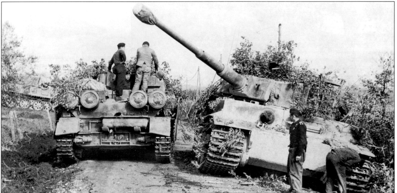
Sturmtiger IV из Sturmtiger-Abteilung 216 проехал мимо поврежденного или обломавшегося «Тигра» Ausf. E из 508-го батальона тяжелых танков, район Анцио. Sturmtiger IV построен на шасси танка Pz.Kpfw. IV Ausf. G. Отверстие под выхлопной патрубок моторчика разворота башни танка в кормовом бронелисте корпуса самоходки закрыт металлическим листом. Правее танкиста, который стоит на крыше моторного отделения, виден колпак вентилятора боевого отделения раннего типа. На заднем плане, левее самоходки, виден полугусеничный тягач Sd.Kfz. 9 Фамо. Тягач готовится к буксировки «Тигра».
