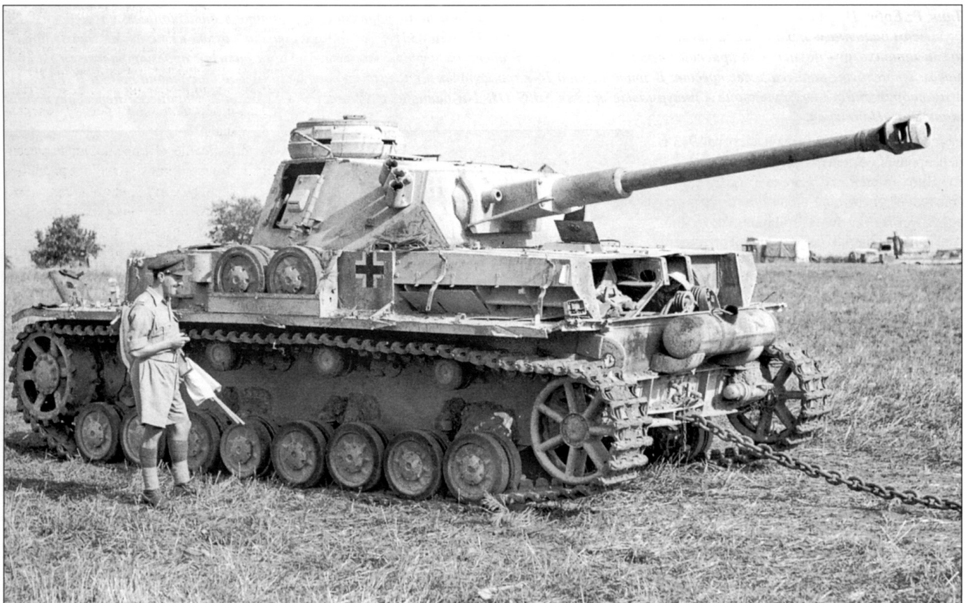
Танк Pz.Kpfw. IV Ausf. G из 2-го танкового полка 16-й панцердивизии, подбитый англичанами под Луцерой в сентябре 1943 г. Противотанковый снаряд попал в правый борт башни, проделав сквозную пробоину и стимулировал детонацию боезапаса, от которой вырвало всю кормовую стенку башни. Танк подготовлен к буксировке на полигон, где проводились испытания воздействия на германскую бронетехнику разных типов мин.
