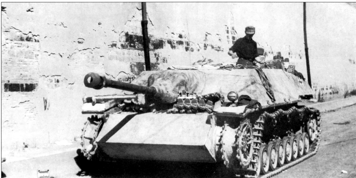
Поврежденный истребитель танков Jagdpanzer IV в ожидании тягача для буксировки в ремонт. Обе гусеницы самоходки порваны. Истребители танков Jagdpanzer IV ранней постройки были вооружены 75-мм орудиями с длиной ствола в 48 калибров. На некоторых пушках имелись дульные тормозы. С января по ноябрь 1944 г. было изготовлено 769 таких истребителей танков. Впервые истребители танков Jagdpanzer IV пошли в бой в составе танковой дивизии «Герман Геринг» весной 1944 г.
