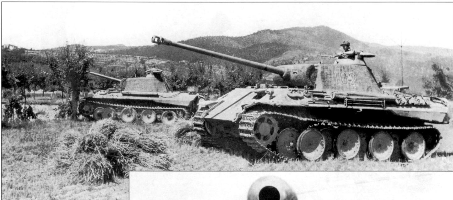
Командирская «Пантера» - Panzerbefehlswagen V Panther Ausf. A - из 1-го батальона 4-го танкового полка, снимок сделан в районе Флоренции летом 1944 г. На борту баши командирского танка написан тактический номер «102». На крыше моторного отделения установлена антенна с «метелкой» на конце. На заднем плане - обычная линейная «Пантера» с тактическим номером «113». Оба танка окрашены в темно-желтый цвет, цифры номеров - красные с белой окантовкой.
