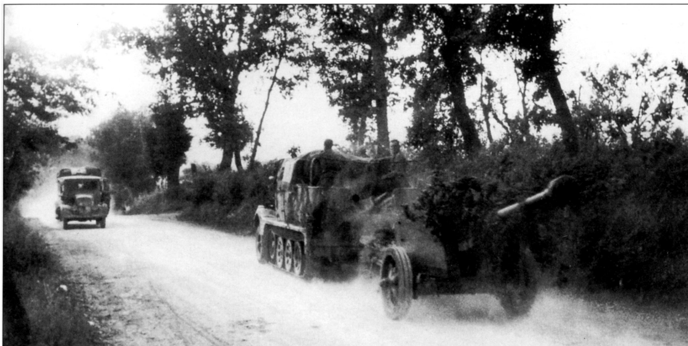
Легкий 3-тонный полугусеничный тягач Sd.Kfz. 11 был предназначен для буксировки гаубиц, противотанковых орудий и минометов «Небельверфер». Здесь на прицепе у тягача Sd.Kfz. 11 противотанковая пушка PaK-40 калибра 75 мм. Щит орудия замаскирован ветками.
