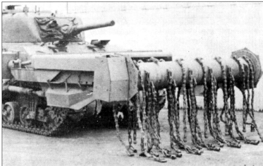
Танк M4A2 «Шерман», оснащенный минным тралом «Краб».
