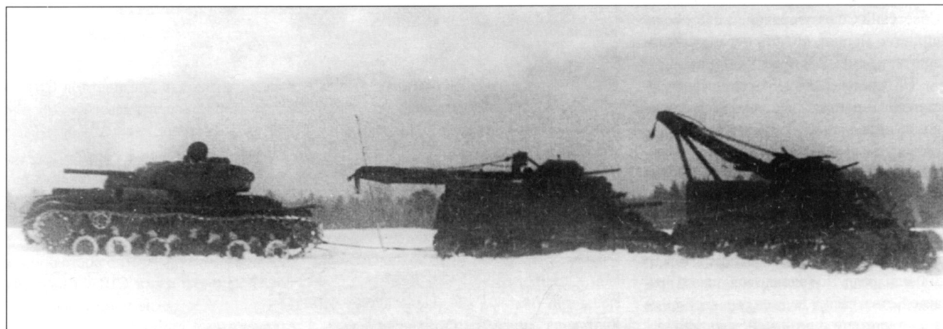
Тяжелый танк KV-1 буксируют два БРЭМ М31 (Т2), полигон НИИБТ, зима 1942/43 гг.
