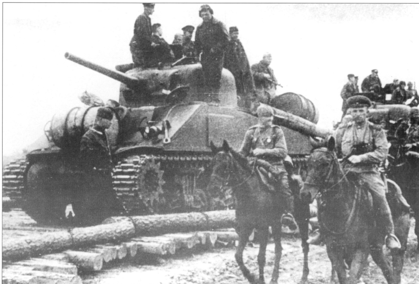
Средние танки М4А2 «Шерман», неизвестная кавалерийская часть, Польша, осень 1944 года. Танк оснащен гусеницами Т49.
