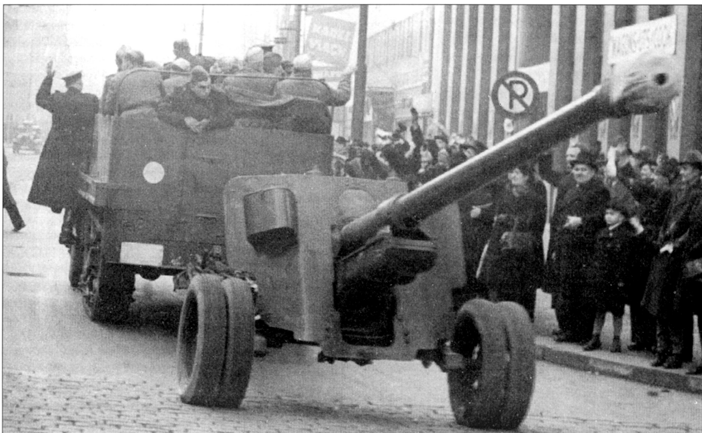
Бронетранспортер М2 из части противотанковой артиллерии буксирует противотанковую пушку БС-3 калибра 100 мм, Прага, октябрь 1945 года.
