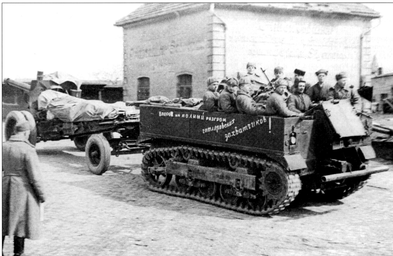
Тягач М5 буксирует 152,4-мм гаубицу-пушку образца 1937 года, Восточная Пруссия, 1945 год.
