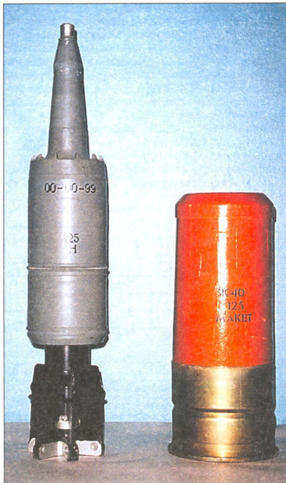
Выстрел ЗВБК16 с кумулятивным снарядом ЗБК18М. На фото слева — выстрел ЗВБК17 с бронейно-подкалиберным снарядом
