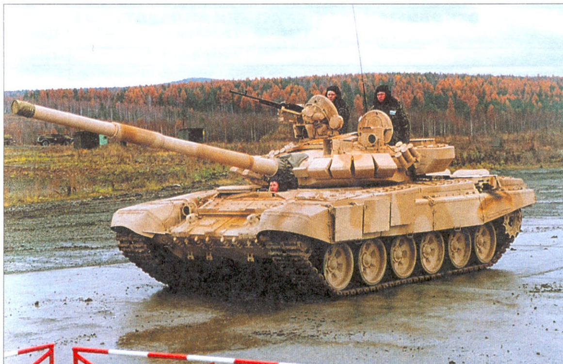
T-90C без комплекса «Штора-1» с ночным прицельным комплексом ТО1-ПО2РТ и двигателем В-92С2, построенный по индийскому заказу
