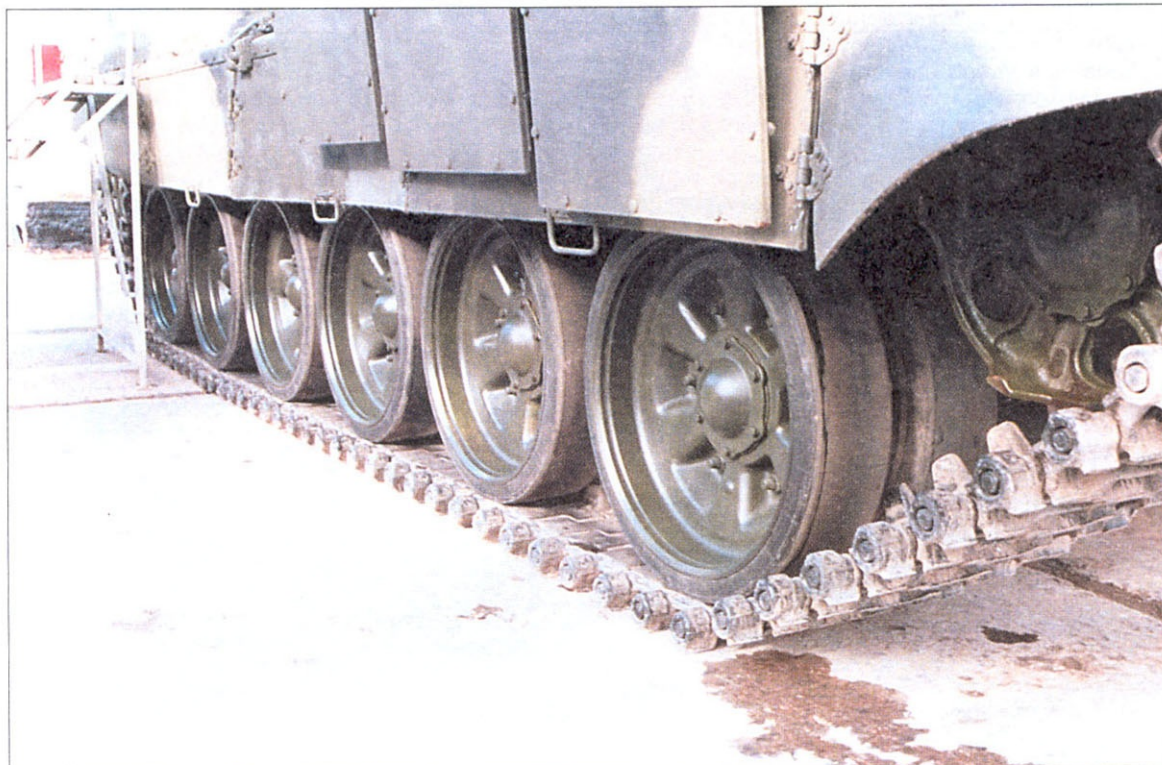
Бортовой резиноканевый экран и экраны с элементами динамической защиты на нем
