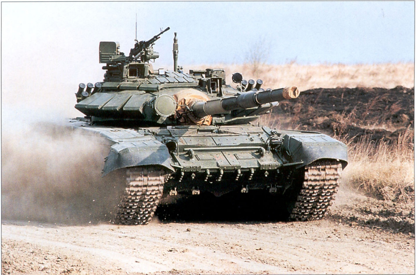
Танк Т-90С с ночным прицельным комплексом Т01-К01
