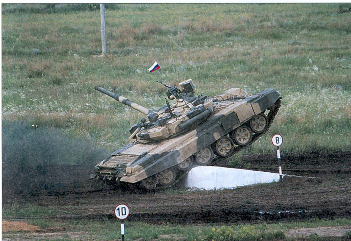
Съезд с вертикальной стенки — испытание для силовой установки и ходовой части танка
