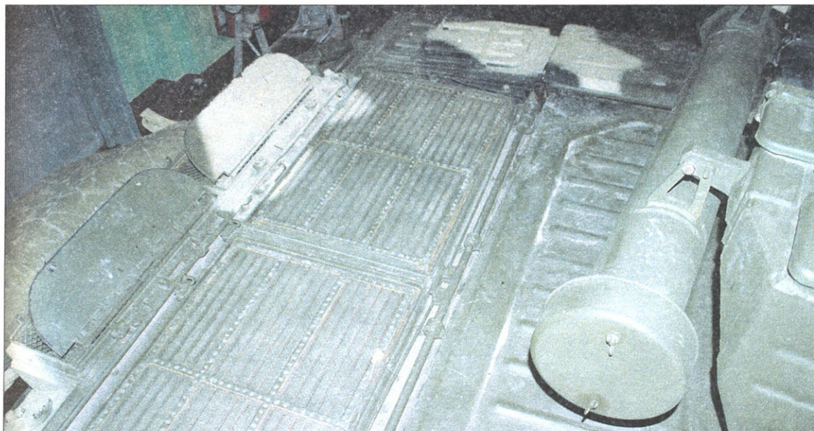
Все оборудование для подводного вождения танка устанавливается за 15 мин
