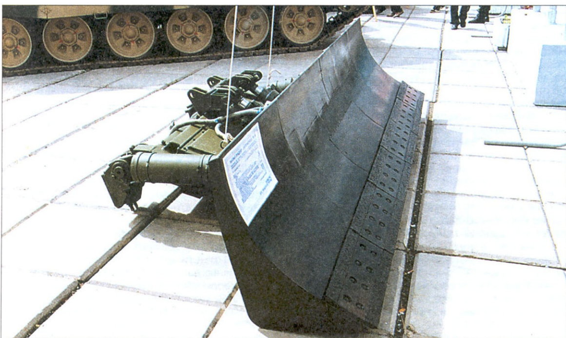
Для работ с грунтом и снегом на Т-90 может навешиваться танковый бульдозер-снегоочиститель ТБС-86
