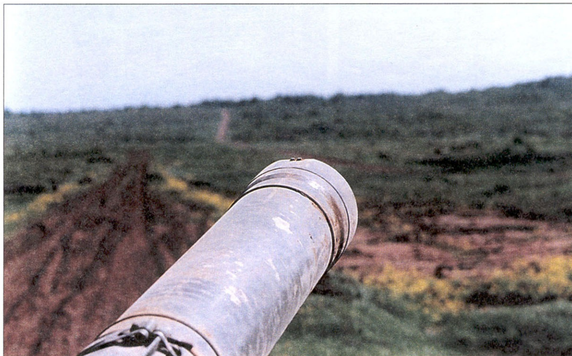
Целик на дульном срезе пушки позволяет производить выверку с прицелом 1Г46
