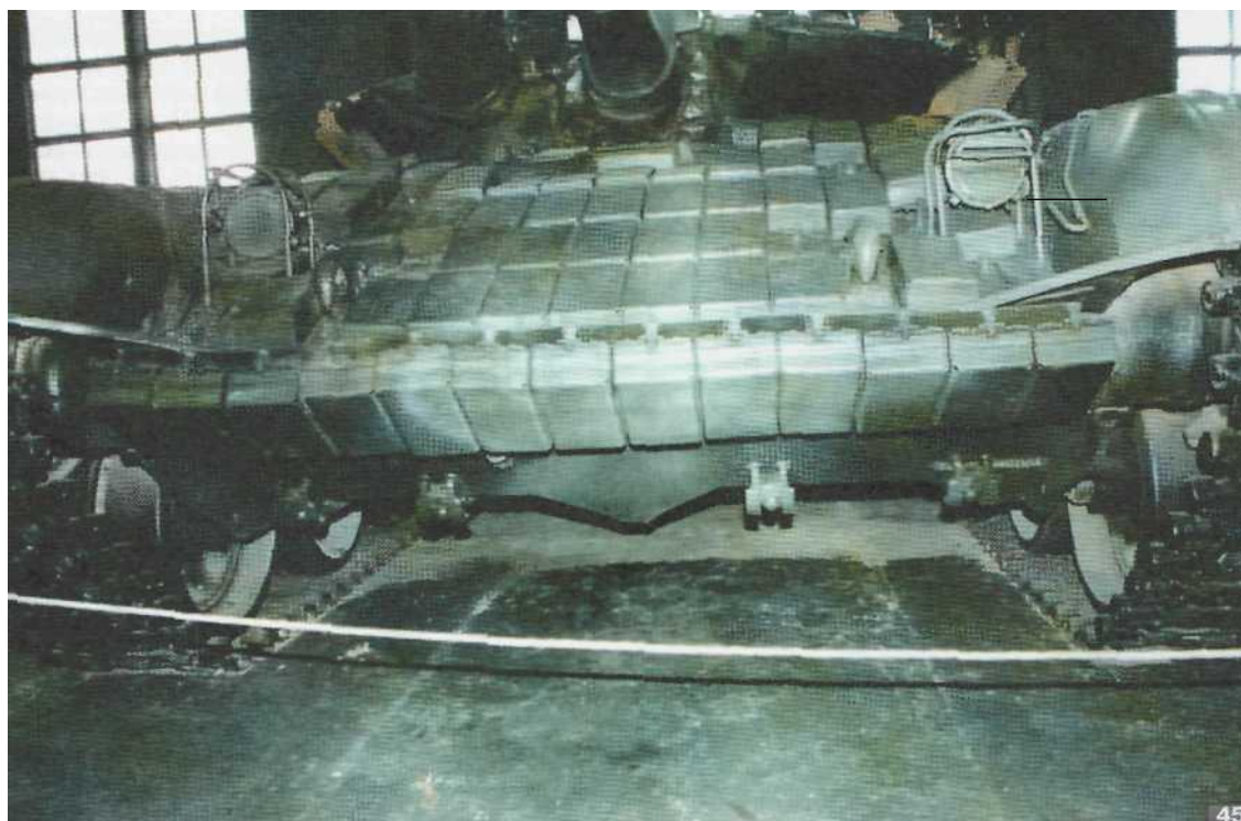
45. Установка элементов ДЗ на лобовой части корпуса танка Т-72АВ.
