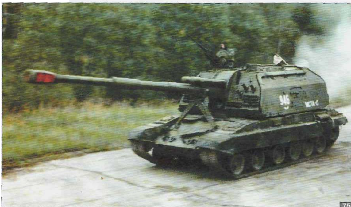
75. Одна из лучших в мире самоходно-артиллерийских установок 2С19 МСТА-С создана на базе Т-72 но ходовую часть использует от Т-80 (фото В.Кораблина)
