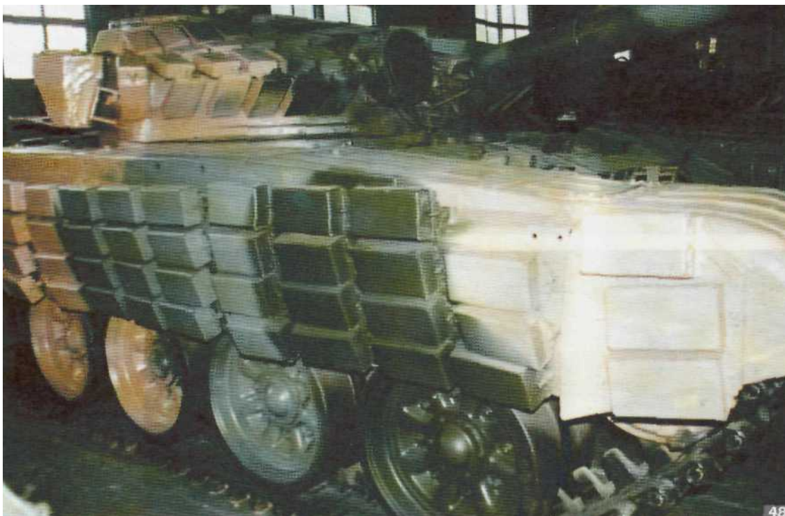
48. Элементы ДЗ на бортовых экранах танка Т-72АВ.
