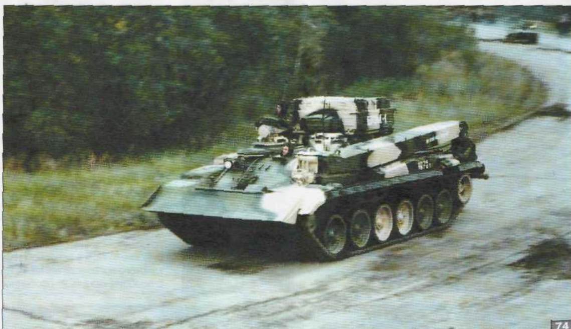
75. Одна из лучших в мире самоходно-артиллерийских установок 2С19 МСТА-С создана на базе Т-72 но ходовую часть использует от Т-80 (фото В.Кораблина)
