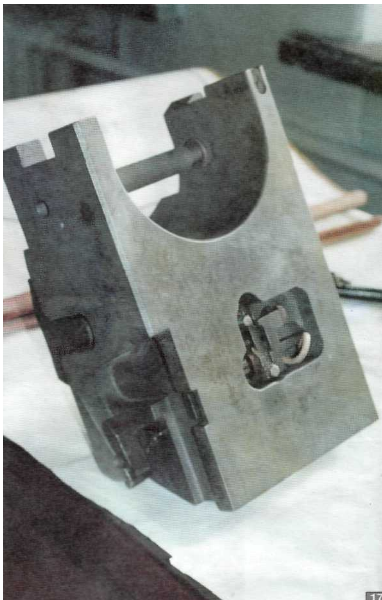
17. Клин затвора танковой пушки 2А46. Чтобы вынуть его из танка при обслуживании пушки, надо иметь хорошие физические данные, ведь он весит 73 кг.
