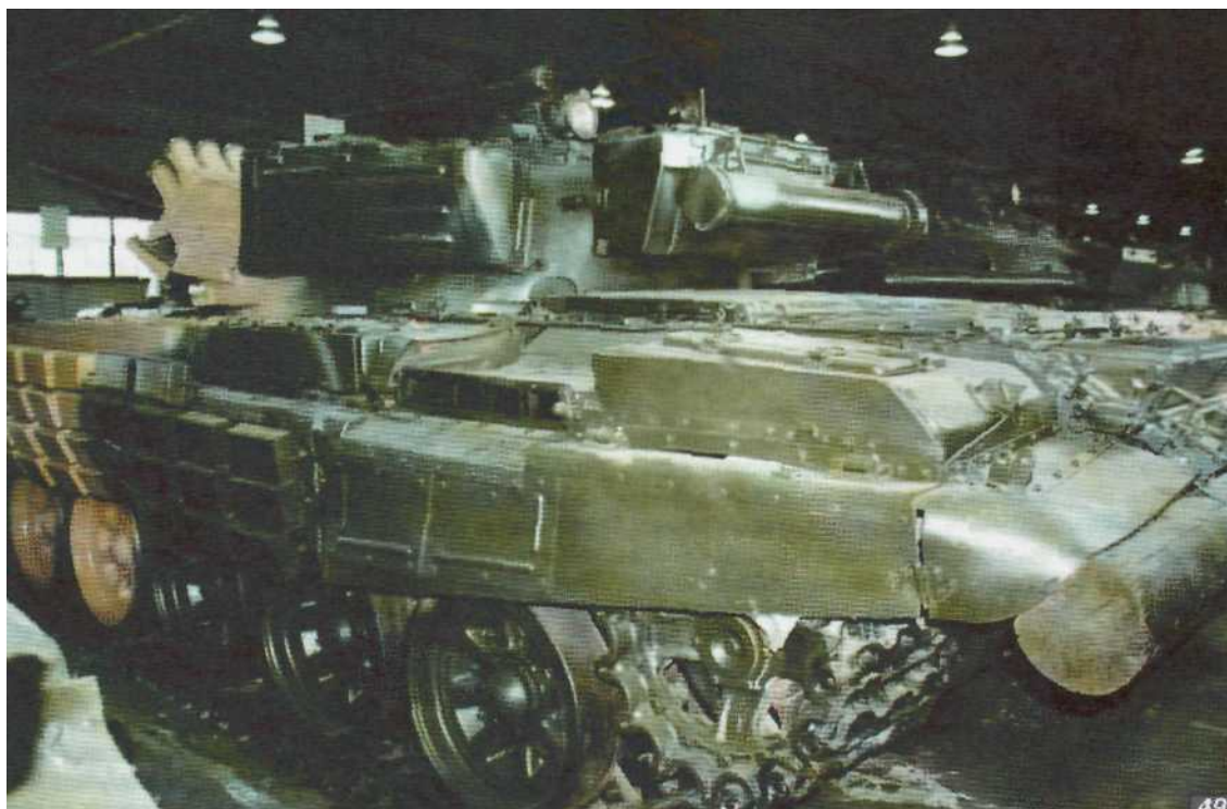
48. Элементы ДЗ на бортовых экранах танка Т-72АВ.
