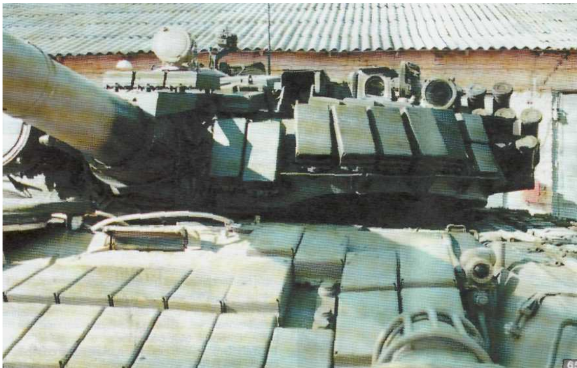
65. Элементы ДЗ корпуса и башни танка Т-72Б. Хорошо виден открытый прицел ППН 1К13 (фото В.Кораблина).
