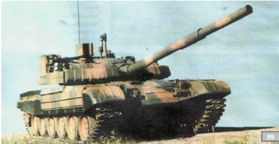
99. Словацкий танк Т-72М2 «Moderna» с 30-мм автоматической пушкой 2А42:
