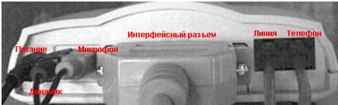
Рис. 1 Подключение соединительных шнуров к модему
